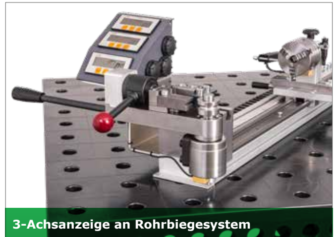
Linearschlitten mit Winkelantrieb und Positionsanzeige
