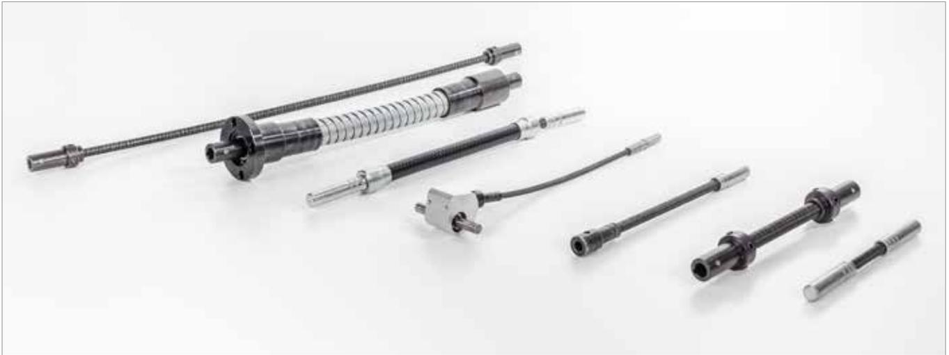
Flexible Wellen sind mechanische Verbindungselemente, die zur Verbindung von zwei nicht ausgerichteten Achsen oder Wellen geeignet sind. Je nach Drehmoment lassen sich Drehbewegungen bei einer Richtungsänderung bis 90° präzise bewegen. Die Ausführungen sind lieferbar mit oder ohne Lagerung und in unterschiedlichen Längen.
