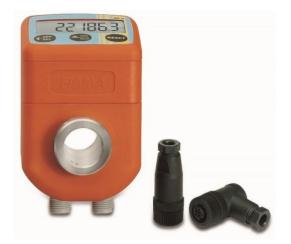
• **EP-RS** mit externer Spannungsversorgung 10-25 VDC und zwei interne wiederaufladbare Batterien (Backup), serieller Ausgang RS485 mit Modbus RTU-Protokoll für die Kommunikation mit dezentralen Geräten.
