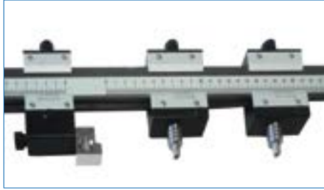
W.INT - Für Abstandsmessung zwischen Löchern
