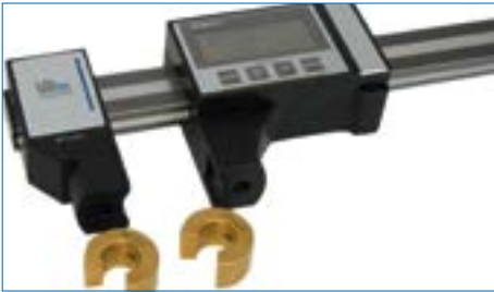
WIGIT992 - Für diagonale Messungen zur Überprüfung der Rechtwinkligkeit
