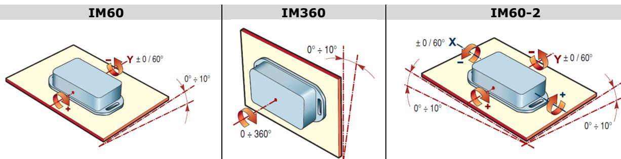
Um das Maß  $0^\circ$  zu erreichen muss der Neigungssensor der Achse auf  $0^\circ$  in Bezug auf die Referenz-Achse montiert werden. Dabei darf der Winkelausschlag auf der zweiten Achse maximal  $10^\circ$  betragen, ggf. eine Wasserwaage benutzen.
